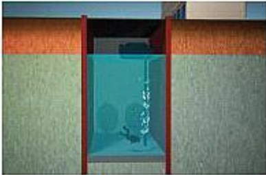
Sichere Methode: Unterwasserbeton
