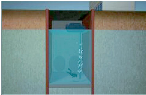
Sichere Methode: Unterwasserbeton. Bild: WDR
