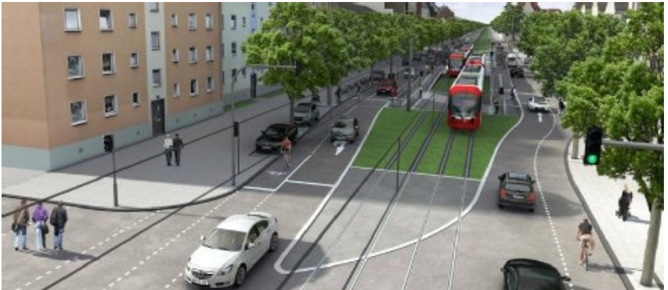
Gleise für die Stadtbahn, mehr Platz für Radfahrer und Fußgänger, aber nur noch eine Spur für Autos: Die Grafik zeigt die künftige Haltestelle Cäsarstraße. Foto: Stadt Köln (Korrektur: Von der Cäsarstraße bis zum Verteilerkreis werden alle Bahnsteige als Mittelbahnsteig realisiert)
